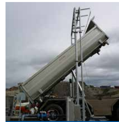
Automatické mytí mostů Automatyczne mycie mostów
